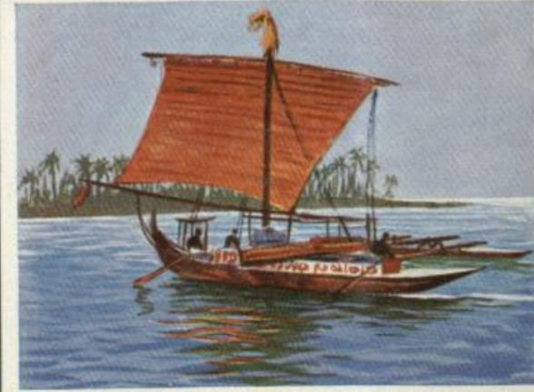
208 **Auslegerboot der Südsee**. Da die aus einem Baumstamm gehöhlten Boote, bes. wenn sie noch Segel tragen sollen, für die Hochsee-Schiffahrt nicht stabil genug sind, werden sie durch eine Stabbrücke mit einem aus leichtem Holz gefertigten Schwimmer verbunden, um das Umschlagen zu verhindern.
