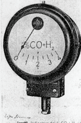
Fig. 234 bis. Indicatore del % \text{CO}_2 tipo in custodia ermetica (Siemens).
