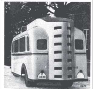
Werkstattdrucke 1942 Bild 3. Omnibus mit 26 Sitzen und Holzgasantrieb. Besatz Prof. Dr. Dietrich. Die Generatoren sind im Heck angebracht und vollständig von außen. Die Luken in der Verkleidung dienen zur Belüftung und sind gleichzeitig Strahlrohre für das Induciergebläse. Zusätzlicher Filter vorerst befindet sich auf dem Dach über dem Dach. Fertigung der Teile und die Deckung der zu erwartenden Kraftstoffnachfrage.
