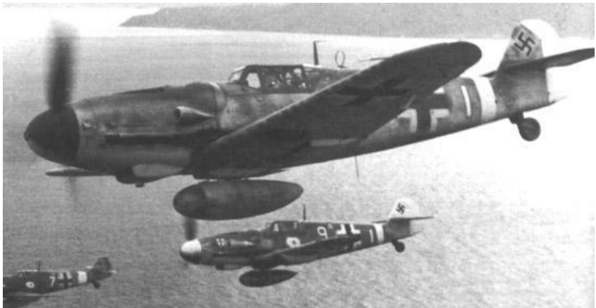
Messerschmitt 109: dos cañones, dos ametralladoras, 1700 caballos de fuerza; 600 kilómetros por hora. Junto con el Focke-Wulf 190 en 1942 conservó el dominio del aire en Rusia.
