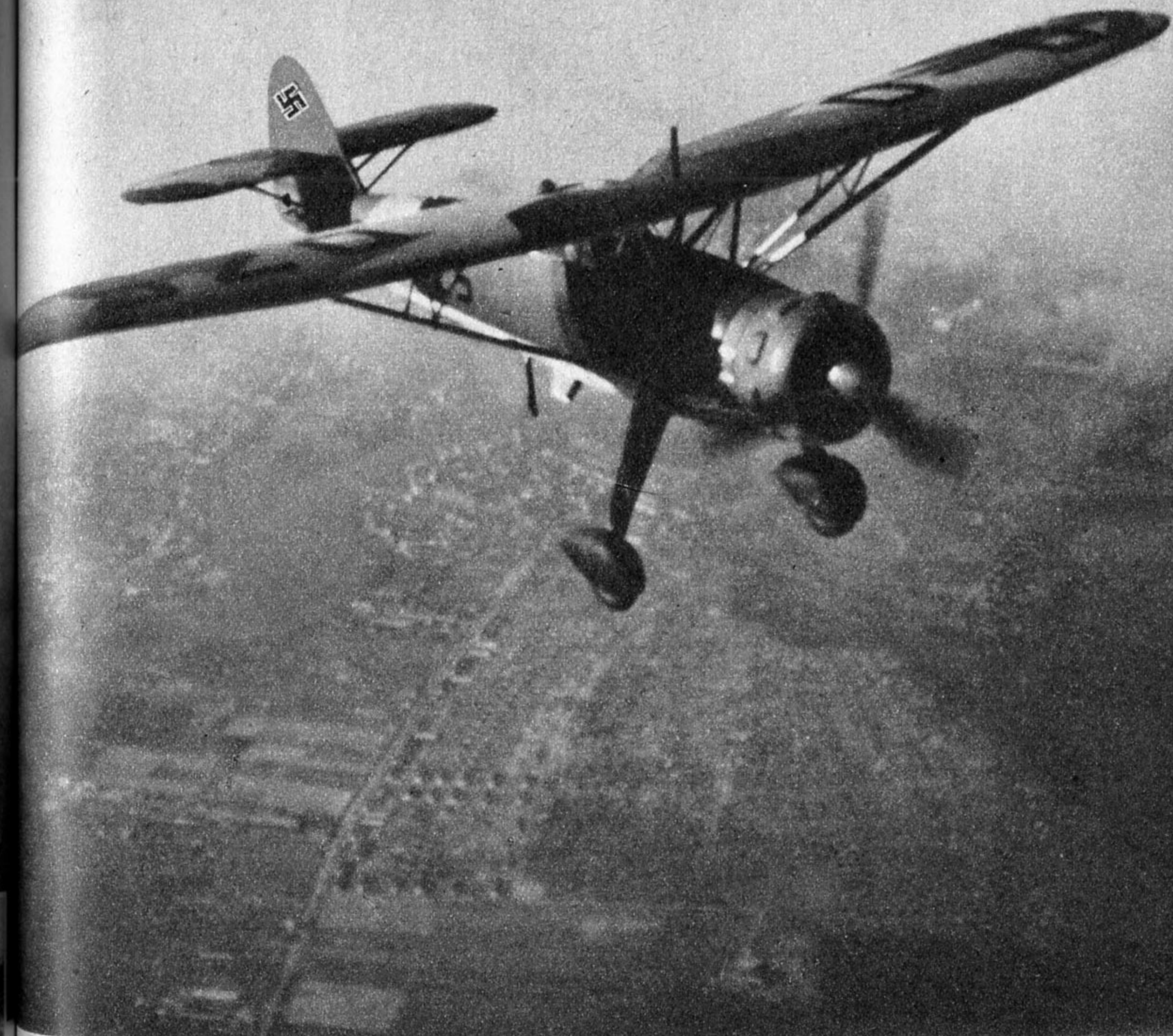
Ein Flugzeug vom Baumuster Hs 126 für Nahaufklärung, das während des polnischen Feldzuges oft und erfolgreich eingesetzt wurde
