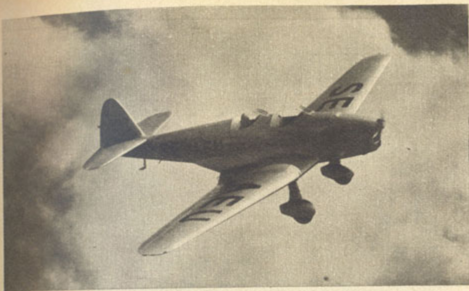
L'avion de sport Klemm Kl 35. Avec une envergure d'aile de 10,4 m, un poids volant de 715 kilos, et une surface de 15,2 m 2 , cet avion a une charge de 47 kilos par mètre carré
