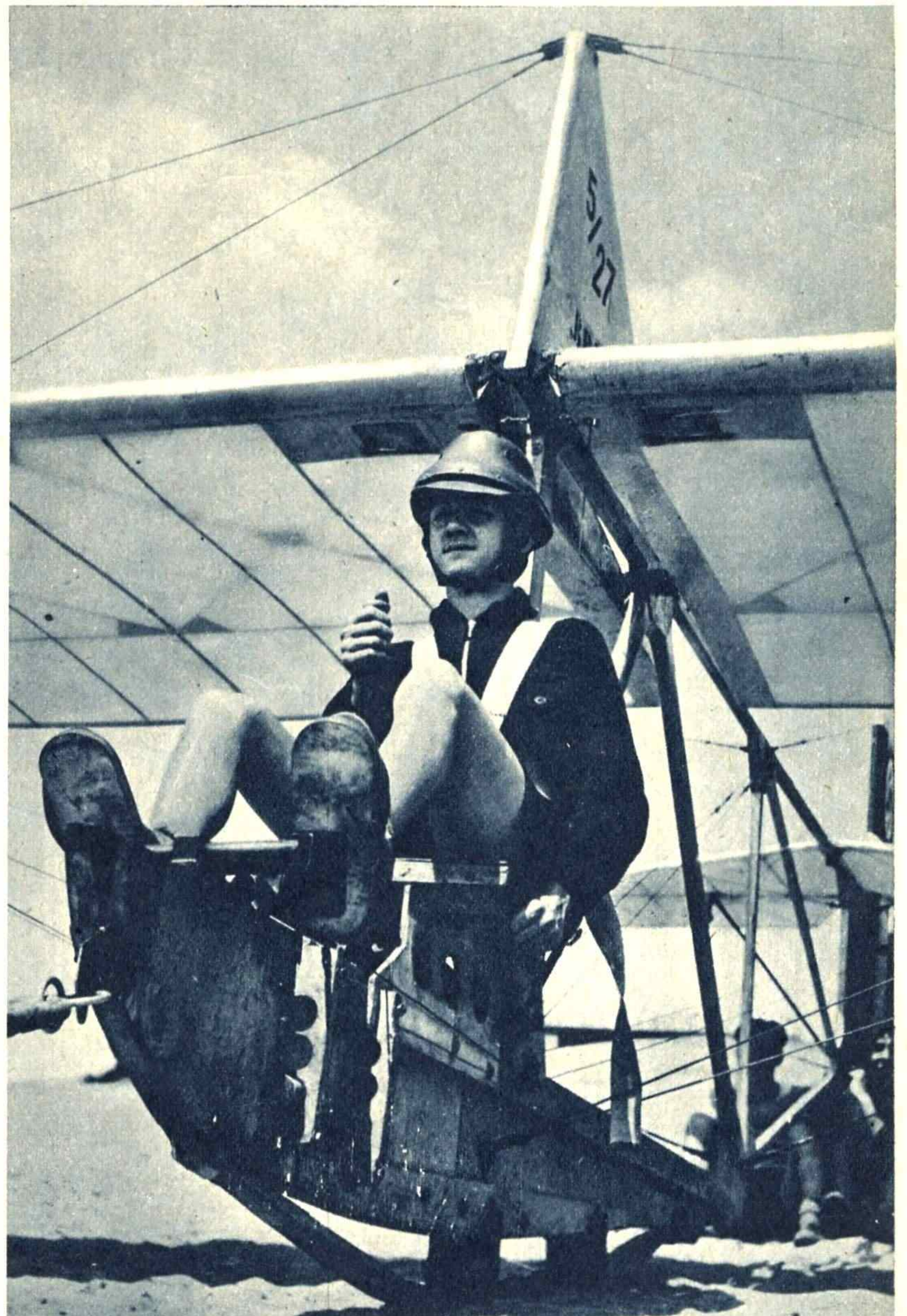
Startfertig! Das Startseil ist vorn in den Starthaken eingehängt. Noch ein Blick auf die Startmannschaft, die gleich das Seil ausziehen wird — dann wird der Gleiter davonschnellen. Aufnahme Fritz Emde
