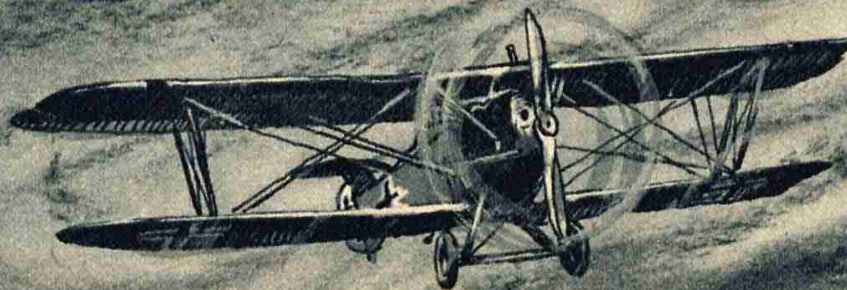
Der Aufklärer der Hannoverschen Waggonfabrik CL IIIa mit 180-PS-Argus-Motor (Baujahr 1918)
