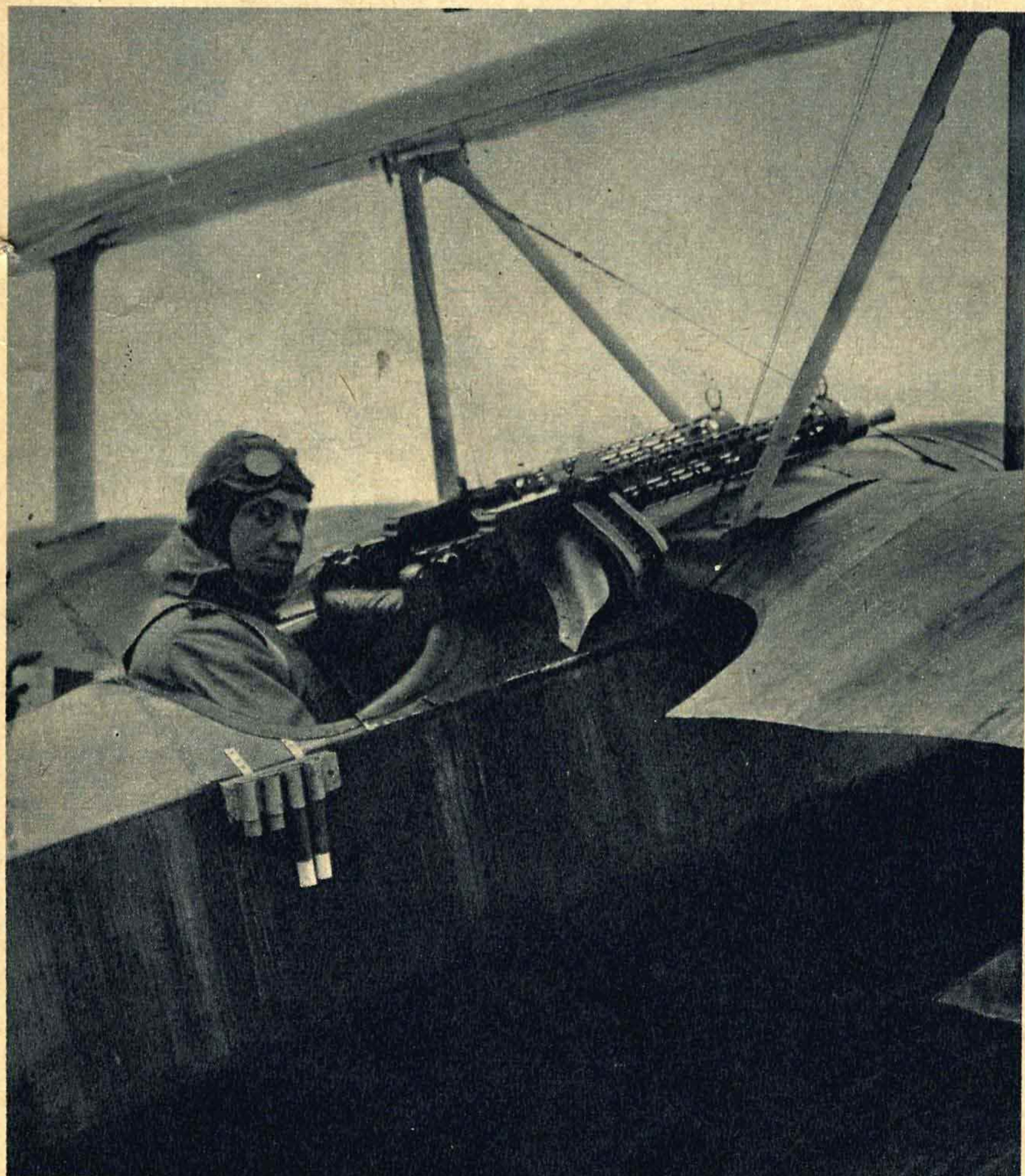
Am Steuer des Fokker-Dreideckers, des zu seiner Zeit schnellsten Jagdflugzeuges. Über der Motorhaube die beiden MG's
