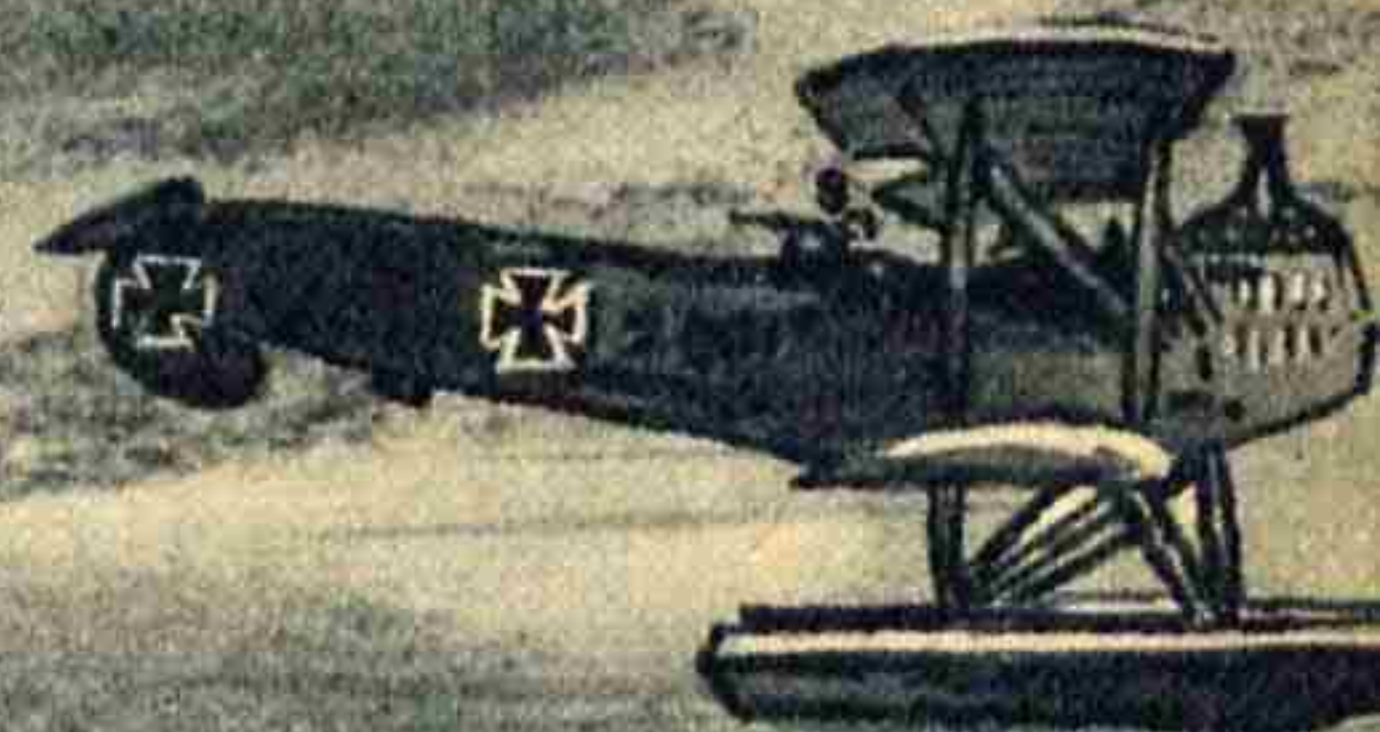
Das erfolgreiche Seekampfflugzeug Hansa Brandenburg W 12, 150-PS-Benz-Motor (1916), eine Konstruktion von Prof. Ernst Heinkel
