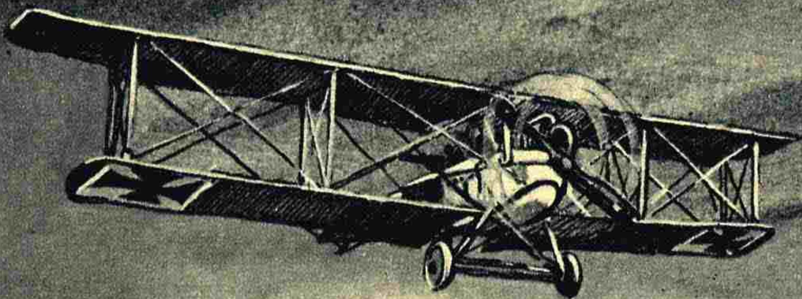
LVG (Luftverkehrsgesellschaft) CI mit 150-PS-Motor, das im Jahre 1915 meistverwendete Aufklärungsflugzeug, ein bewährtes Baumuster, das noch bis Kriegsende auf den Fliegerschulen benutzt wurde
