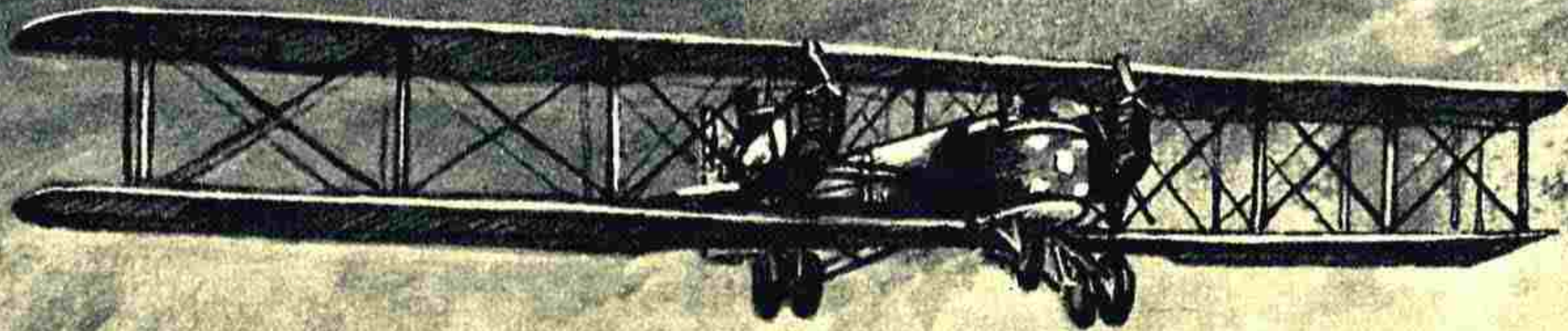
Ein ebenfalls bewährtes Bombenflugzeug, die „Friedrichshafener“ G 3 mit zwei Mercedes-Motoren von je 260 PS (Baujahr 1917/18)
