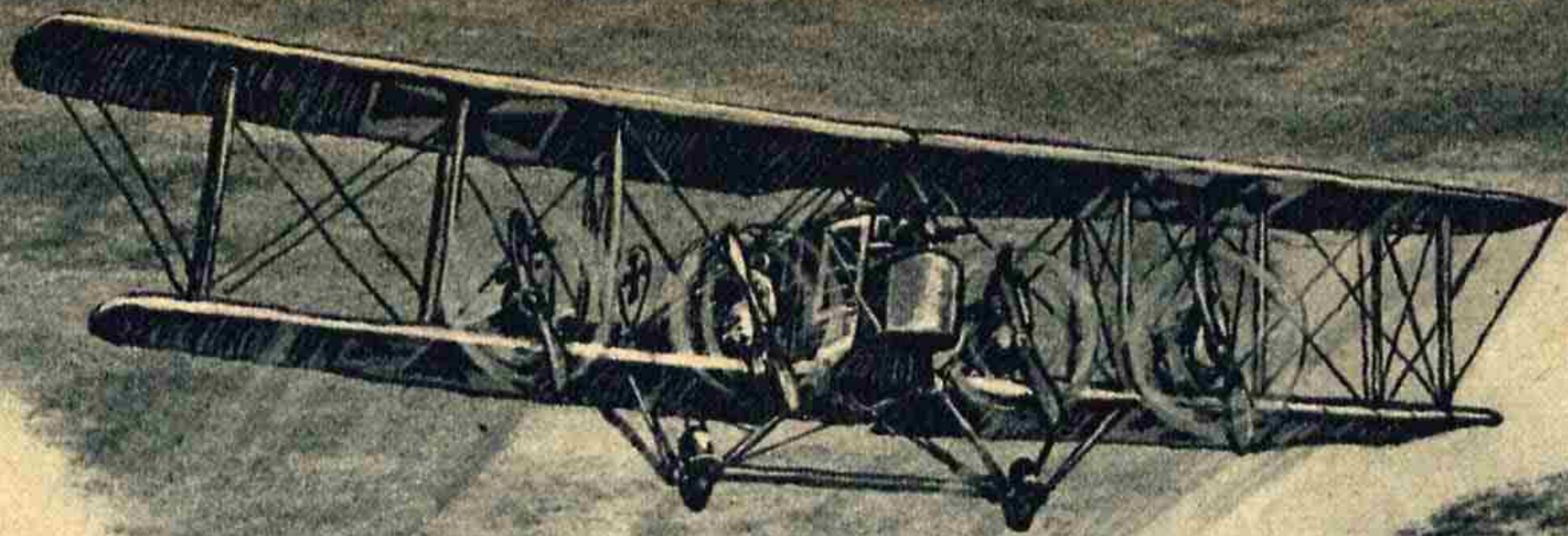
Das Riesenflugzeug der Siemens-Schuckert-Werke aus dem Jahre 1918 mit 4 Mercedes-Motoren von je 160 PS. Es fand als Nachtbombenflugzeug Verwendung
